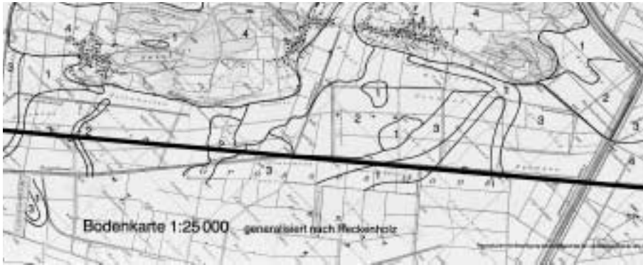
Abb. 8 Die Bodenkarte von 1970 zwischen Aspi-Gut und Kanalmühle zeigt die stark wechselnde Bodenbeschaffenheit im Bereich des Aarberger Kanals: 1) Moor, 2) Toniger Lehm, 3) Auenböden, 4) Braunerde.
